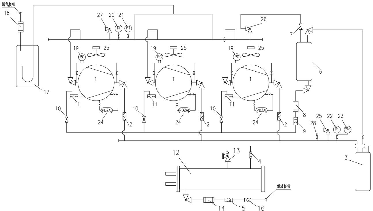
1、压缩机 2、减震管 3、油分离器 4、排气球阀 5、排气单向阀 6、储油器 7、压差止回阀 8、油过滤器 9、视油镜 10、回油手阀 11、油位控制器 12、储液器 13、安全阀 14、干燥过滤器 15、视液镜 16、供液管球阀 17、气液分离器 18、吸气过滤器 19、高低压控制器 20、低压表 21、低压传感器 22、高压表 23、冷凝压力控制器 24、电子式油压保护器(仅限于带油泵的压缩机) 25、缸头风扇(仅对低温机) 26、截止阀 27、截止阀 28、保压接头
