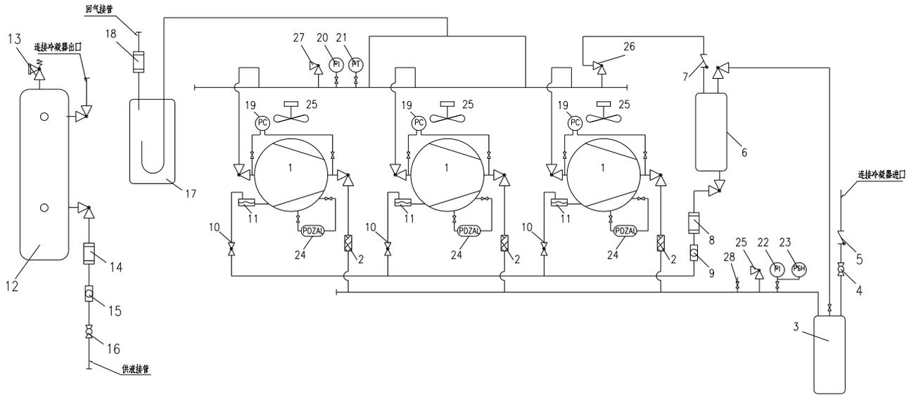
水冷并联机组组成示意图：
